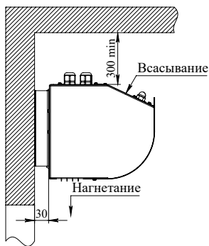
ГОРИЗОНТАЛЬНАЯ УСТАНОВКА к стене с помощью кронштейнов
